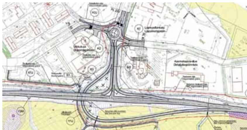
Plankorsningen i Läpp ska förbättra trafiksäkerheten vid infarten till Karis. Skiss: Ramboll Finland
